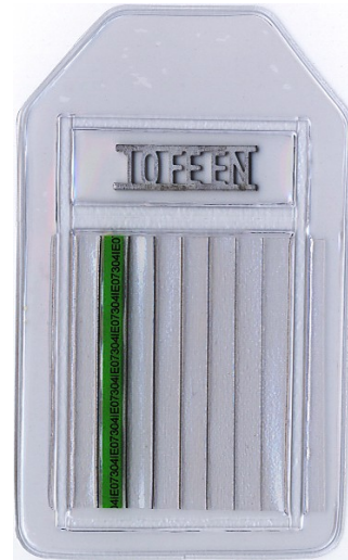
Fig. 1 Wire type IQI
